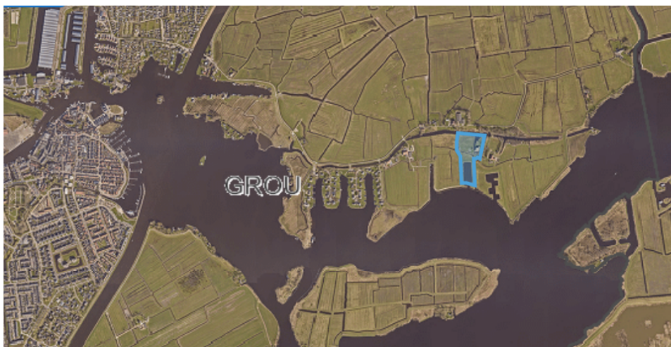
Luchtfoto uit 2022 met blauw opgelicht het perceel Burd 20. Deze luchtfoto maakt inzichtelijk dat er 25 hectare landbouwgrond is afgegraven met als gevolg dat er een nieuw meer en eiland is ontstaan. Op het perceel Burd 20 is een opvaart/haven afgegraven die in verbinding staat met dit meer.
